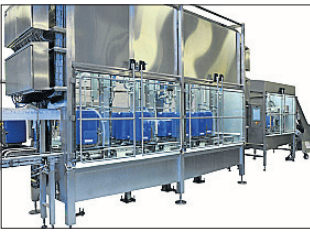
Fyldeanlægget fra Varo skal kunne fylde 400 forskellige kemiske væsker med en pH-værdi mellem 1-14. Foto: Varo
